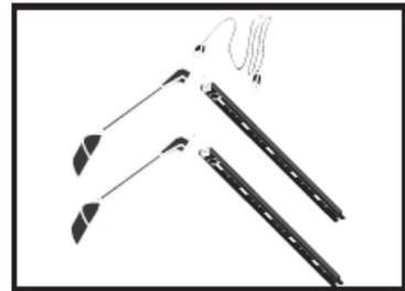
Das obere Drittel der Magnetschiene nochmal herunterklappen und Lampen am oberen Ende der Schiene anbringen und in die gewünschte Position drehen.
