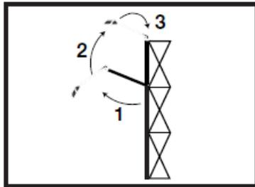
Das obere Drittel der Magnetschiene wieder nach oben klappen und mit der Lampe vorsichtig von oben einhängen/ einschieben. Auf diese Weise benötigen Sie im Normalfall keine Steighilfe, um die Lampen anzubringen.
