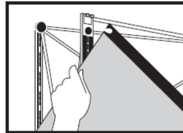
**Anbringen der Vorderbahnen:** Grafik etwas aus der Schutzhülle ziehen, die Bahn oben in die Stifte der Magnetschiene einhängen. Erst links, dann rechts einhängen. Jetzt erst Schutzfolie abziehen und ordentlich zur Seite legen. Grafik langsam auf die Magnete „klicken“.
