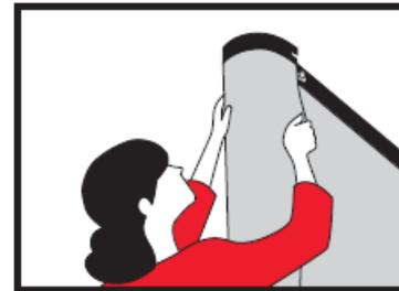
**Anbringen der Endkappen:** Endkappe nach hinten umbiegen. In Stifte (vorne und hinten) einhängen (erst auf Vorder- dann auf Rückseite). Mit beiden Händen parallel an Grafik entlang langsam nach unten streifen. Erst loslassen, wenn die Grafik unten auf den Magneten haftet! Klickendes Geräusch ist zu hören.
